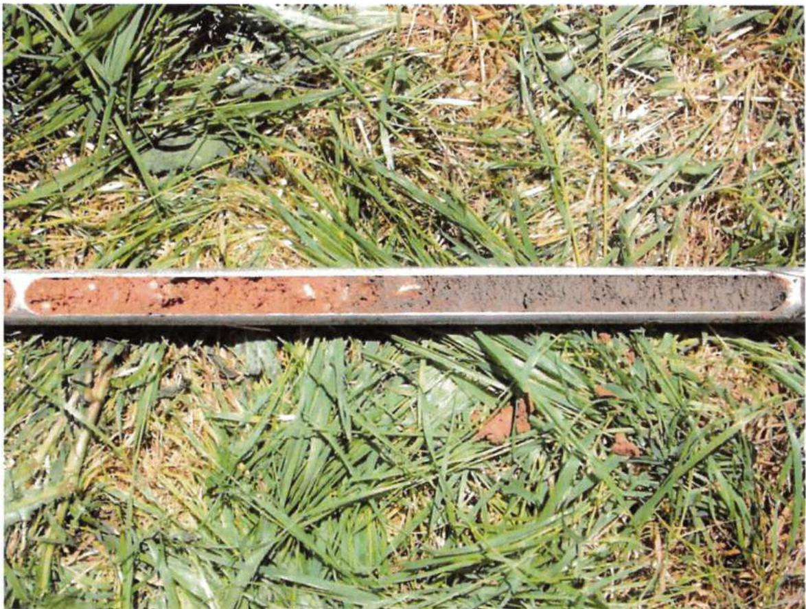
Bild 4: Parzelle 4, Schluff, schwach feinsandig unter Schluff, schwach kiesig, bei 2,0-2,5 m.
