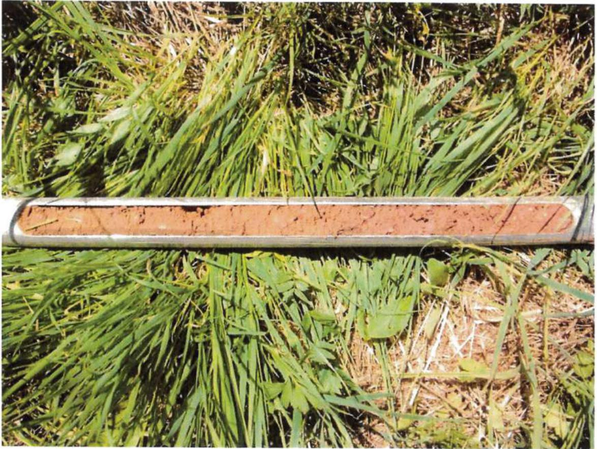
Bild 5: Parzelle 7, Bereich 1,0-1,5 m, Schluff, schwach kiesig, schwach sandig.
