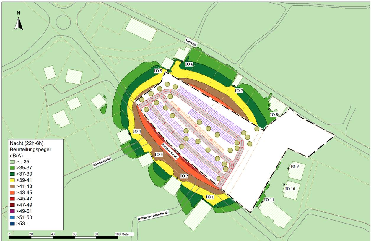
Abbildung 7: Raster des Beurteilungspegels im Nachtzeitraum für die Variante Normalauslastung
