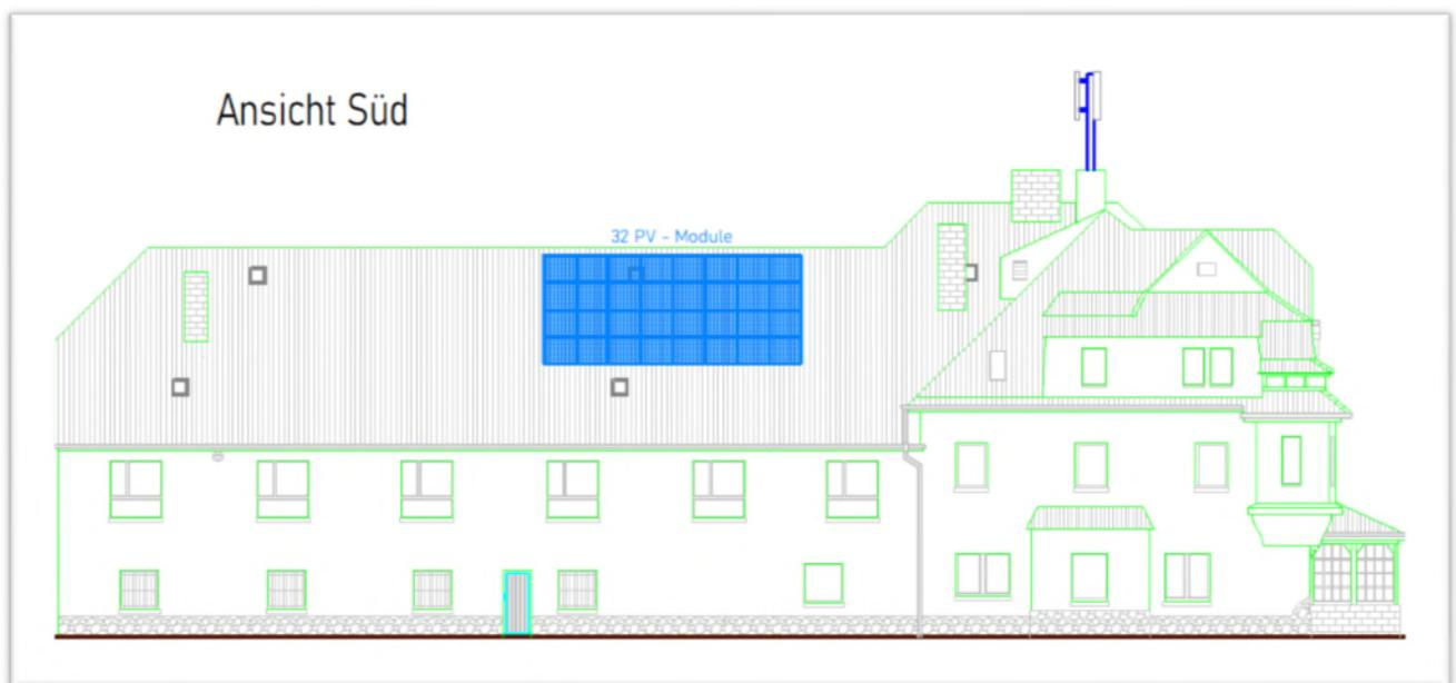
Abbildung 1: Südansicht mit 32 Solarmodule
