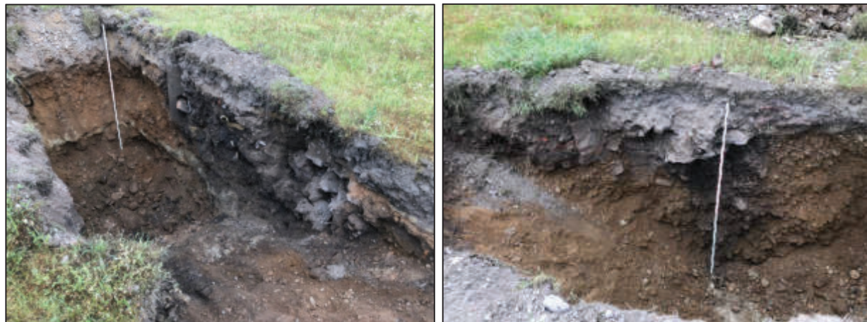
Abbildung 3: Aufgeschlossen Bodenhorizonte in den Baggerschürfen Sch1 und Sch2
