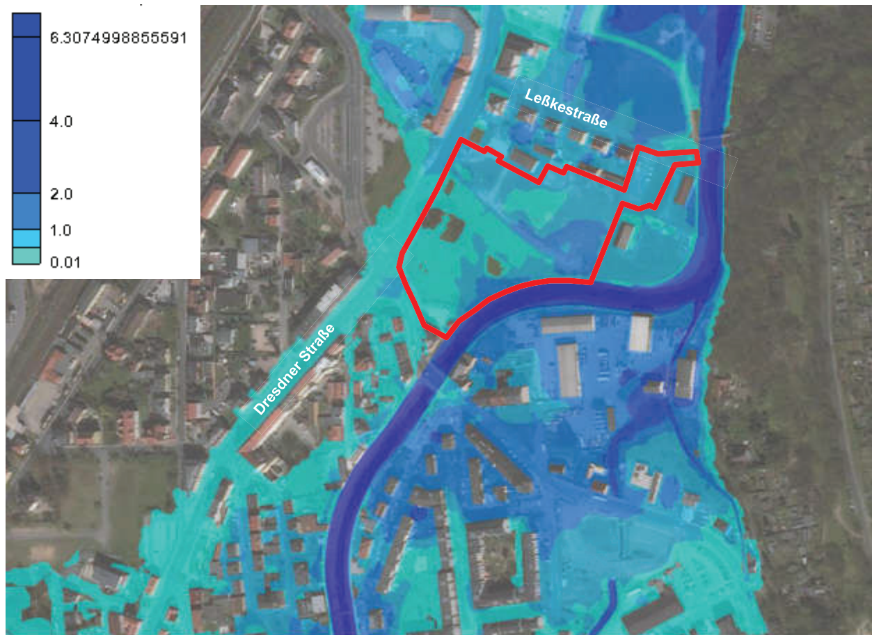
Abbildung 2: Modell Istzustand - berechnete Wassertiefen (in m) bei einem Hochwasserabfluss analog zum Ereignis 08/2002 (rot = Plangebiet)
