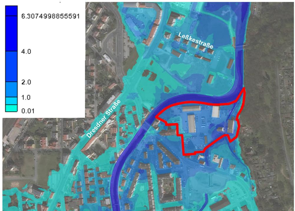
Abbildung 4: Istzustand - berechnete Wassertiefen (in m) bei einem Hochwasserabfluss analog zum Ereignis 08/2002 (rot = Plangebiet) [Bildquelle: /P7/]
